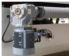
高端齿轮变频减速机，平稳持久耐用且与德国博世力士乐变频器控制输送速度达到理想砂光效果。
