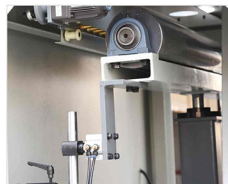
砂带清洁装置，清除粘在砂带上的粉尘延长砂带使用寿命，提高砂光质量。
